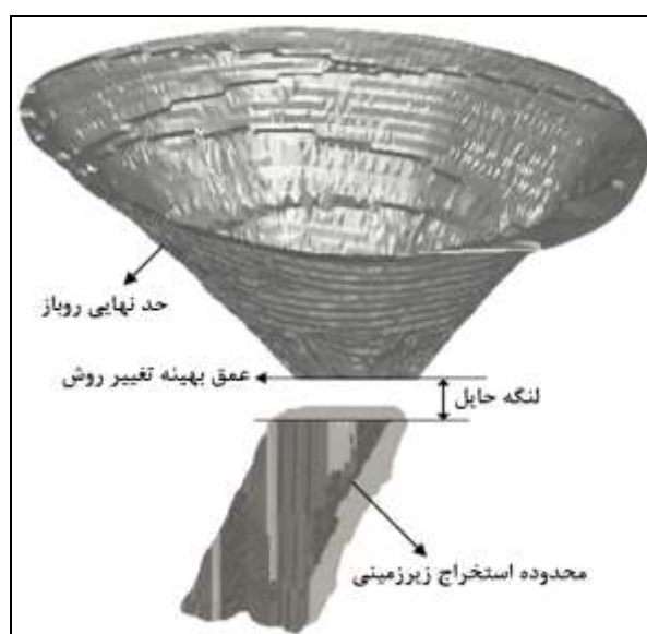
شکل ۳-۱- تغییر روش استخراج از روباز به زیرزمینی
